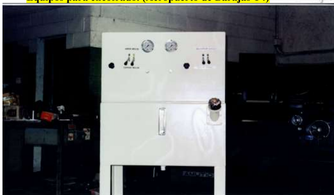
Grupo hidráulico de panel.
