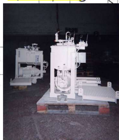
Grupo hidráulico encofrado exterior túnel (Ponferrada)
