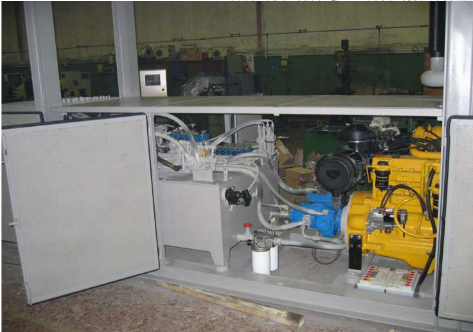
Grupo hidráulico para carro elefante de 1x75Tm.(Puerto de Luanco)
