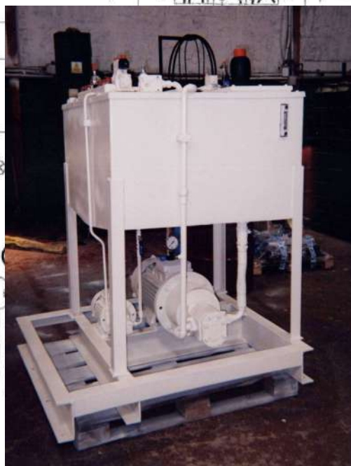
Grupo hidráulico Presa de Baglihar (India)
